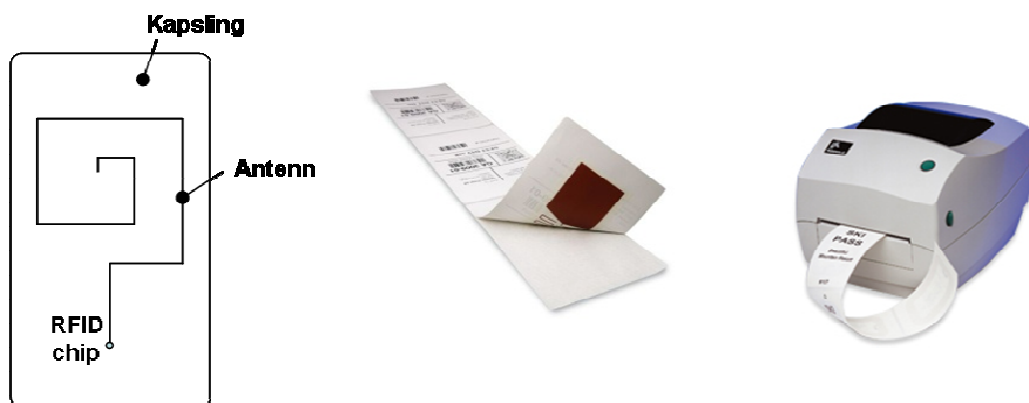
Figur 1:Principskiss passiv RFID etikett, exempel på etiketter utskrivna av en RFID skrivare samt en RFID skrivare (Dehlin et al., 2010)
